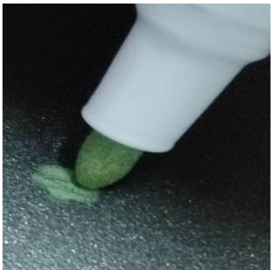
Figura 8-9: Assorbimento dell'inchiostro sulla punta del Gi-PEN
